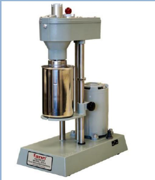
Instrumento utilizado para medir la viscosidad y la resistencia de gel de un lodo de perforación.
