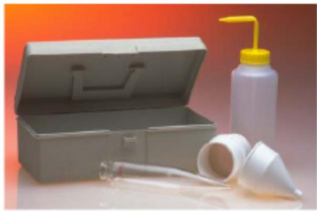
Observación: Al efectuar la prueba de un fluido de perforación de base aceite; utilice en lugar de agua dulce, un combustible ligero (petróleo diáfano o diésel).
