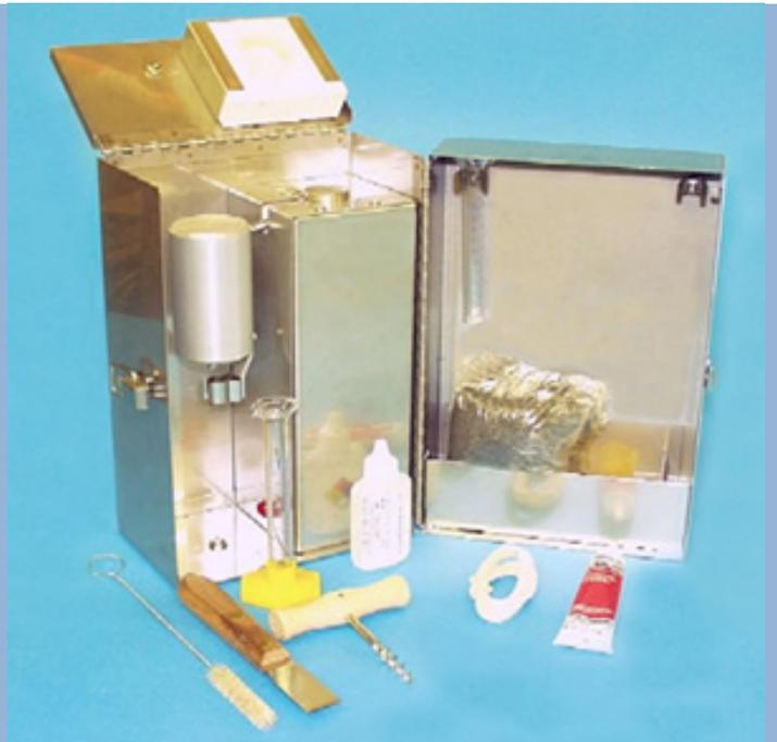
Esta prueba consiste en colocar el fluido por analizar en el recipiente y calentarlo vaporizando los componentes líquidos. Los vapores pasan a través de una unidad condensadora y el líquido es recolectado en la probeta que esta graduada en tanto por ciento (%); de esta forma se mide el volumen de líquidos. La diferencia de este con el del fluido analizado, será la medida del volumen de los sólidos.
