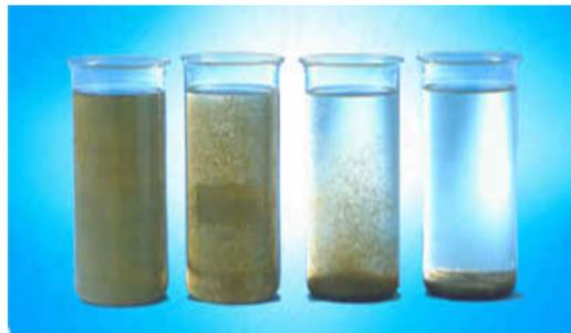
**Filtración:** Es un tipo de separación mecánica, que sirve para separar sólidos insolubles de grano fino de un líquido en el cual se encuentran mezclados; este método consiste en verter la mezcla a través de un medio poroso que deje pasar el líquido y retenga el sólido. Los aparatos usados se llaman filtros; el más común es el de porcelana porosa, usado en los hogares para purificar el agua.
